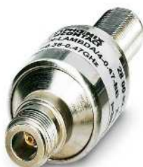
Para instalações TETRA (380 MHz – 470 MHz), blindagem aterrada, conexão: tipo N
