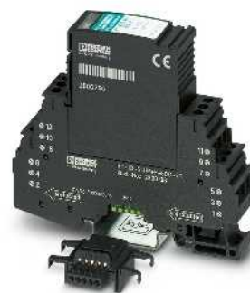
5 condutores com potencial de referência comum, conexão 9/10 aterrada através de condutor de descarga de gás
